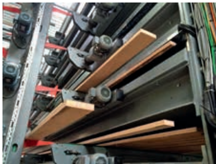
Abbildung 10: Weitertransport der belemten Lamellen
