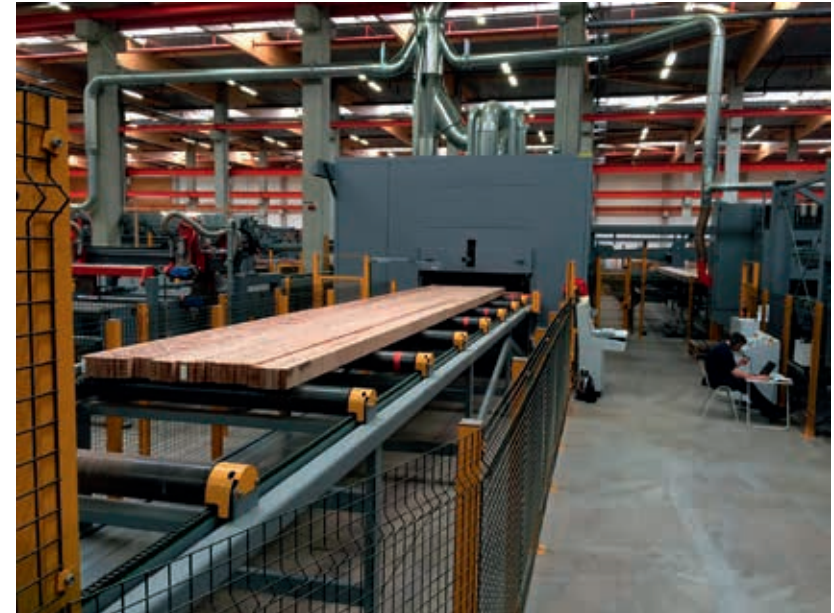
Abbildung 12: Träger BauBuche GL 75 beim Einlauf in die Schleifmaschine
