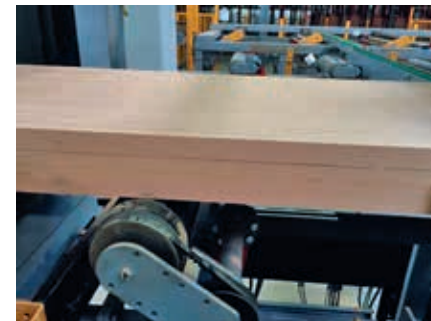
Abbildung 13: Träger BauBuche GL 75 beim Auslauf aus der Schleifmaschine
