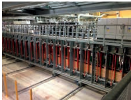
Abbildung 11: BauBuche GL70 in der Balkenpresse
