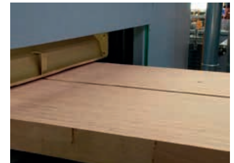
Abbildung 14: Auftrennen der BauBuche Träger zur BauBuche Panel
